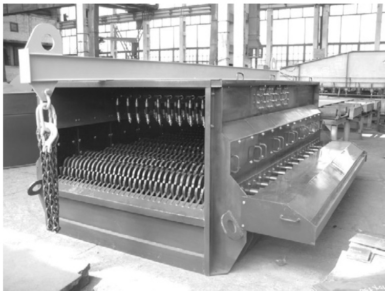
Рис. 3. Водовіддільник дисковий «ТМА-ВДФ-6.04»
